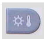
Konfor sıcaklığı butonuna basarak ayarladığınız değer, otomatik çalışma, parti ve sürekli konfor modlarında referans alınacak oda sıcaklığını belirler.
