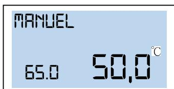
Ekranda yanıp sönen değer istenilen kazan suyu sıcaklığına ayarlanır. Sağ taraftaki sıcaklık ise mevcut kazan suyu sıcaklığıdır. Manuel çalışma modunda bütün pompalar aktiftir. Karışım vanaları enerjisiz olduğundan el ile kontrol edilebilir. Çalışma modu seçimi butonuna basarak manuel moddan çıkarılır.
