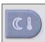
Ekonomi sıcaklığı butonuna basarak ayarladığınız değer, otomatik çalışma, ekonomik ısıtma ve dışında modlarında referans alınacak indirgenmiş oda sıcaklığını belirler.
