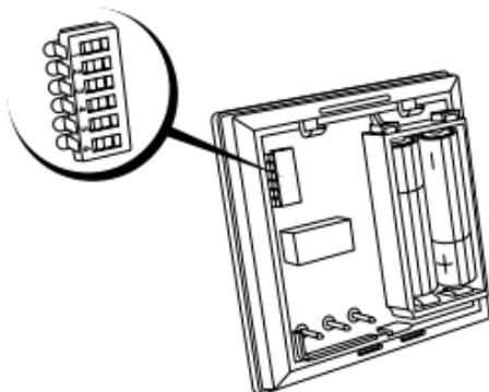
**AAN/UIT** - Output wordt ingeschakeld bij temperatuur lager dan ingestelde temperatuur en uitgeschakeld bij temperatuur hoger dan ingestelde temperatuur. (Omgekeerd in koelmodus.)
