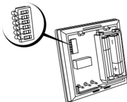
**on/off** - la chaudière s'enclenche et se déclenche selon un différentiel de température fixe.
