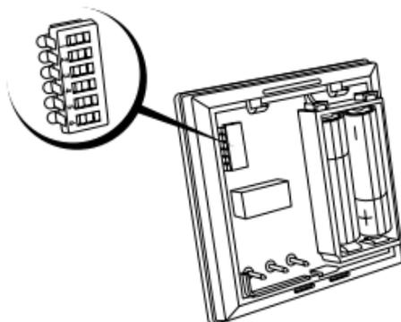
**ON/OFF** - Heizung wird eingeschaltet, wenn die Temperatur unter dem eingestellten Wert liegt und ausgeschaltet, wenn sie darüber liegt (im Kühlmodus genau umgekehrt).
